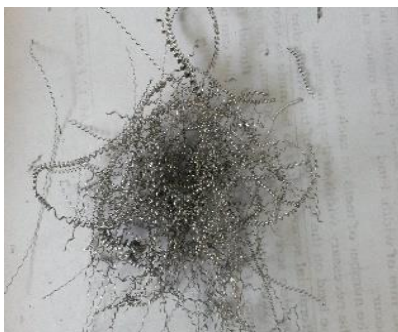
s=112\text{mm/min} , f=0.045\text{mm/rev} & d=0.5\text{mm}
