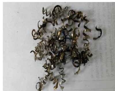
s=710\text{mm/min} , f=0.16\text{mm/rev} & d=2.5\text{mm}
