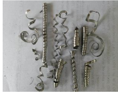
s=180\text{mm/min} , f=0.063\text{mm/rev} & d=1\text{mm}
