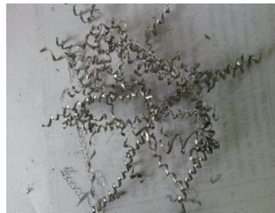
s=450\text{mm/min} , f=0.063\text{mm/rev} & d=2.5\text{mm}
