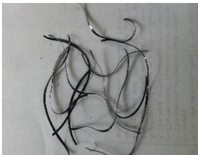
s=180\text{mm/min} , f=0.063\text{mm/rev} & d=1\text{mm}
