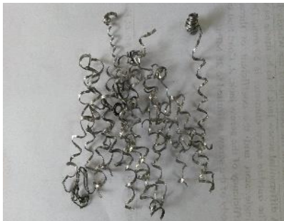
s=280\text{mm/min} , f=0.09\text{mm/rev} & d=0.5\text{mm}
