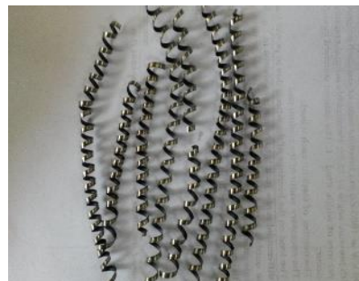
s=180\text{mm/min} , f=0.16\text{mm/rev} & d=2\text{mm}
