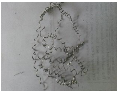
s=180\text{mm/min} , f=0.063\text{mm/rev} & d=1\text{mm}
