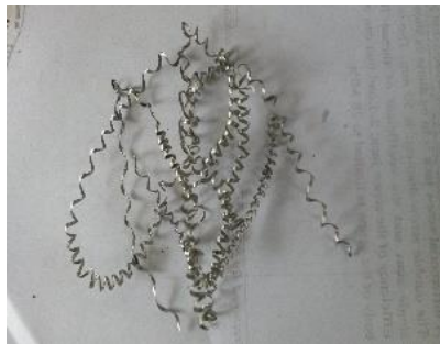
s=710\text{mm/min} , f=0.063\text{mm/rev} & d=1\text{mm}
