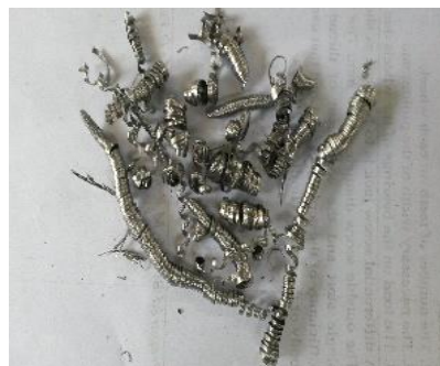
s=112\text{mm/min} , f=0.09\text{mm/rev} & d=0.5\text{mm}
