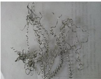
s=280\text{mm/min} , f=0.09\text{mm/rev} & d=1.5\text{mm}
