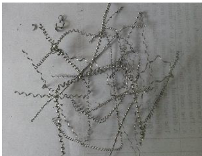
s=450\text{mm/min} , f=0.125\text{mm/rev} & d=2\text{mm}
