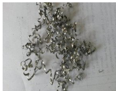
s=180\text{mm/min} , f=0.063\text{mm/rev} & d=1\text{mm}
